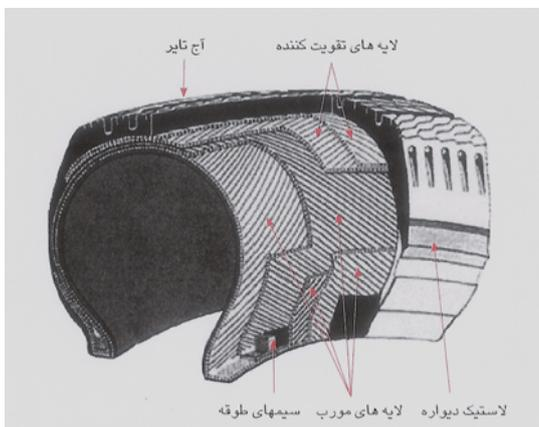
یک تایر بایاس از چند لایه (معمولاً) زوج تشکیل شده که نخ های تشکیل دهنده هر لایه با یکدیگر موازی و امتداد نخ در هر لایه، زاویه مشخصی با خط مرکزی تایر می سازد. تایرهای بایاس به گونه ای طراحی می شوند که آمیزه ترد آن در برابر سایش بسیار مقاوم است و آمیزه سایدوال آن می تواند به مقدار زیادی بارهای دینامیکی را تحمل کند. کاراکس شامل نخ و سیم و آمیزه است. طوقه باعث قرارگیری مناسب پاشنه تایر روی رینگ می شود و به ناحیه پایین منجید استحکام می بخشد.
