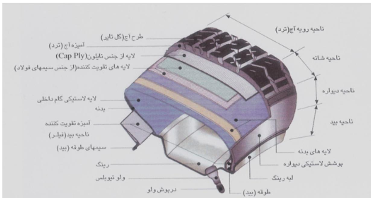
به دلیل ساختار ویژه تایرهای رادیال آج و دیواره آن به صورت جداگانه عمل می کنند. از این رو آج تایر هنگام خم شدن دیواره ها تحت تأثیر قرار نمی گیرد. پس آج تایر تغییر شکل کمتری روی زمین خواهد داشت و این یعنی سایش کمتر و حرارت زائی کمتر.
