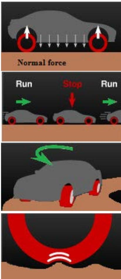
از دیدگاه مکانیکی، تایر یک ساختار الاستیک دارد که از منجید منعطف با قدرت کشش بالا تشکیل یافته است که دو سر نخ ها به دور طوقه ها که به طور محکم به رینگ می چسبند، حلقه زده اند. فشار داخلی تایر، ساختار مکانیکی آن را به گونه ای تحت تأثیر قرار می دهد که هرگونه نیروی خارجی که به تایر وارد می شود، منجید را با تغییر شکل مواجه ساخته و باعث بروز نیروهای عکس العمل در تایر می شود.
